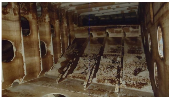
Slika 24 Prikaz sedimenta u balastnom tanku
