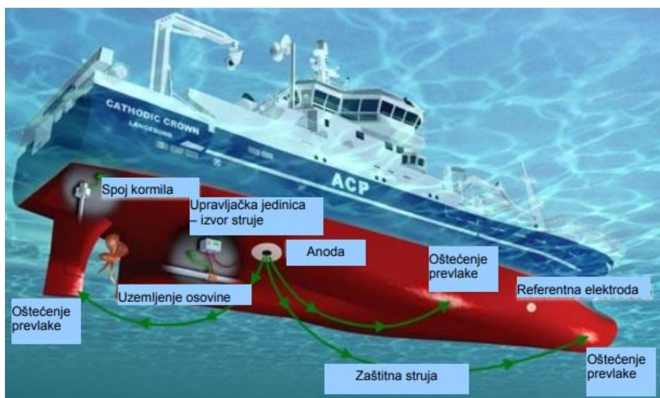
Slika 13 Primjer sustava katodne zaštite na brodu (preuzeto:
