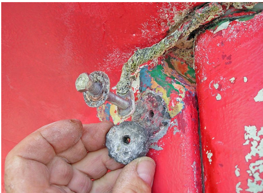
Slika 15 Primjer istrošenog cink protektora (preuzeto: http://nautica-portal.com/forum/index.php?topic=5103.30 )
