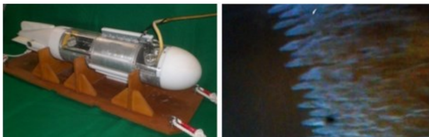
Slika 23 Tegljena istraživačka podmornica i tok zraka ispušten iz rasprskaača (preuzeto: https://www.mhi.co.jp/technology/review/pdf/e521/e521050.pdf )
