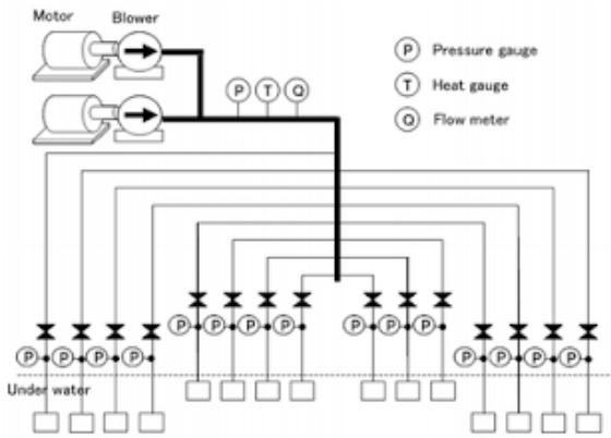
Slika 24 Shematski prikaz napajanja MALS sustava zrakom (preuzeto:
