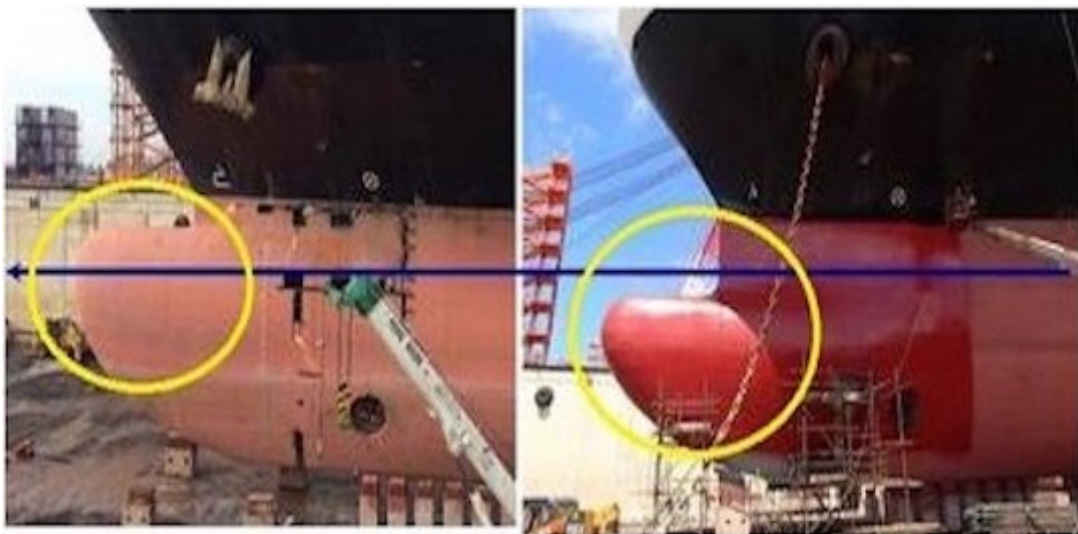
Slika 5 Izmjena konstrukcije pramčanoga bulba (preuzeto:
