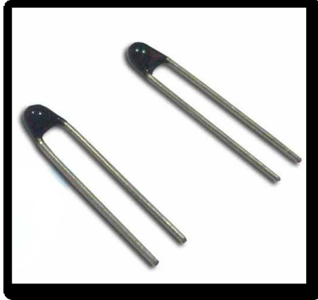
Slika 13. Poluvodič termorezistora s kuglicom [13]
