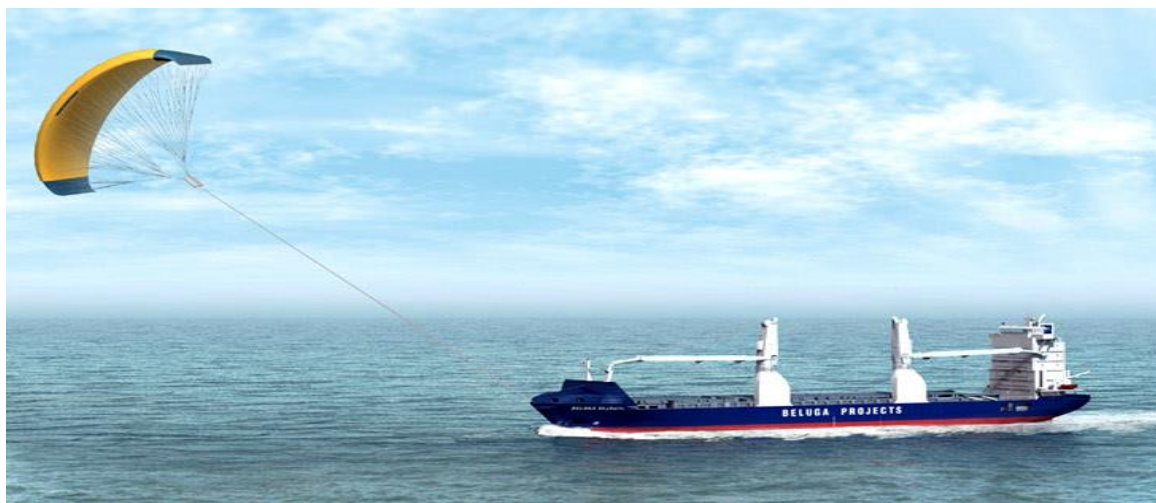
Slika 8. Prikaz broda u trenutku korištenja skysailsa [8]
