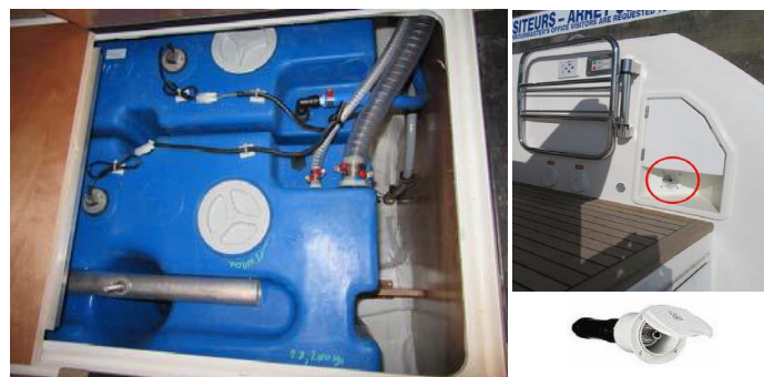
Slika 27. Tank vode i priključak vodu s kopna [3]
