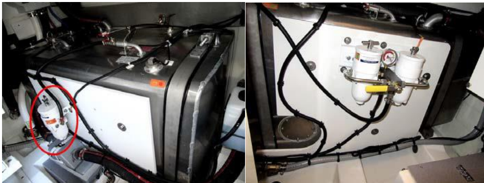
Slika 8. Filteri goriva (fini i predfilter) [3]
