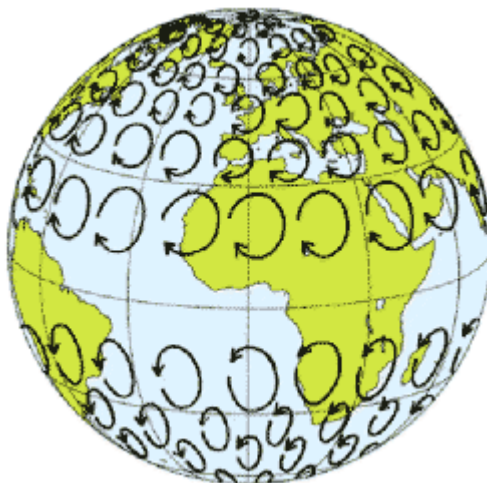
Slika 2. Shematski prikaz smjera gibanja struja u izostanku drugih sila osim Coriolisove;
